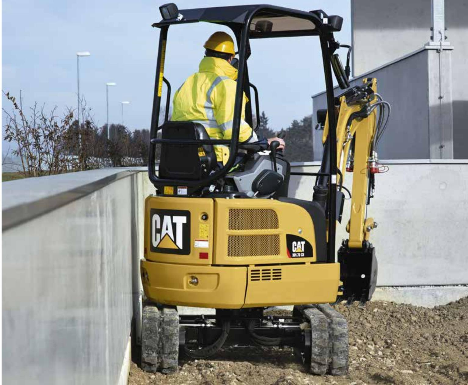
L'ingombro di rotazione minimo del Cat 301.7D CR consente di lavorare comodamente in spazi ristretti con il telaio superiore della macchina in grado di farsi largo entro uno spazio ampio quanto la larghezza dei cingoli. Questo design a raggio compatto permette anche di concentrarsi sul lavoro da eseguire, senza doversi preoccupare di arrecare danni alla parte posteriore della macchina o nel cantiere.
